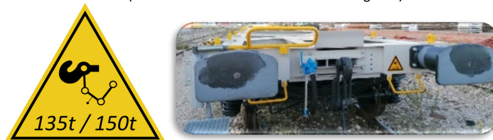
Ilustración 1: Marcado que identifica que el vehículo cuenta con un gancho G.A.R.
