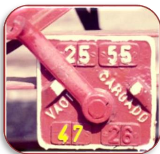
Ilustración 6: Palanca de cambiador de potencia manual en posición "vacío"
